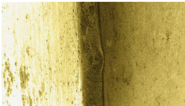
LPKFハイブリッド溶着は常に接合部がコンパクトであり、優れた結果を得られる(50倍)
