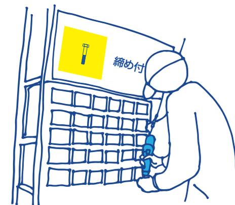
トルクレンチの完了信号も連動させることが出来ます。締め付け回数を間違えると、ポカヨケ機能により棚が赤く光りブザーが鳴動します。
