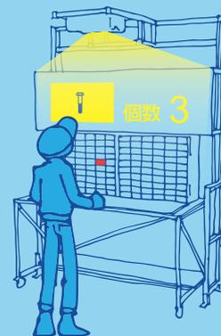
**2** 指示書のバーコードをスキャンし、PPS により作業指示を投影させます。その後、光った引き出しの間口より部品を取り出します。
