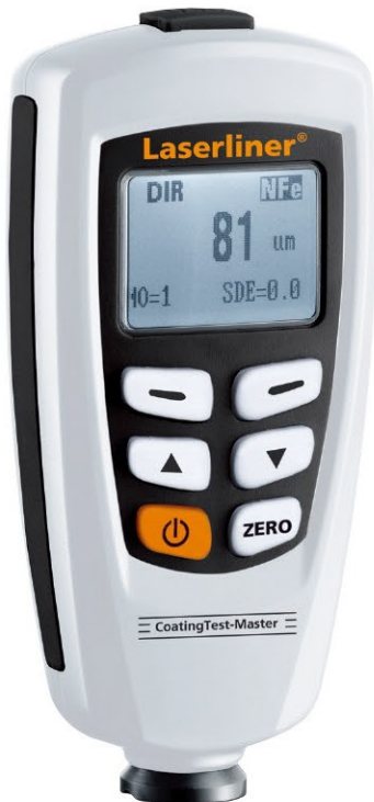
鉄/磁性金属(Fe)、非鉄/非磁性金属(NFe)の自動素地識別
