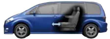
パワーシート
