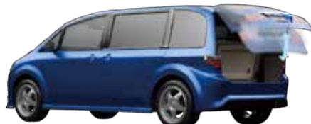
パワーバックドア
